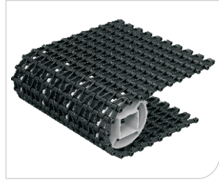
Type 型号 : HS-2600B Pitch 节距 : 25MM Thickness 厚度 : 11MM Open area 开孔率 : 44%
